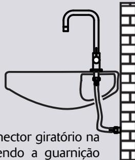
Rosqueie a extremidade do conector giratório na torneira ou misturador, mantendo a guarnição posicionada. Não precisa de veda rosca, pois a vedação é feita pela guarnição.
