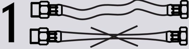
Não instalar o flexível esticado. Verificar o comprimento necessário para a instalação.
